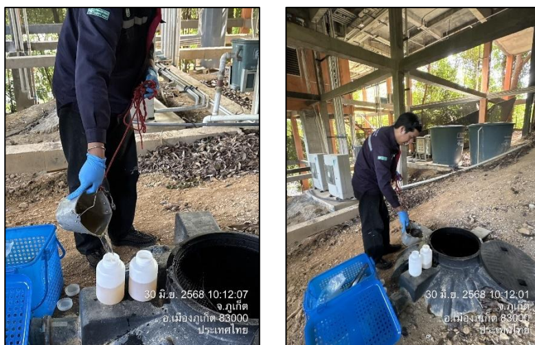
รูปภาพที่ 3.1 การเก็บตัวอย่างน้ำผ่านการบำบัด
